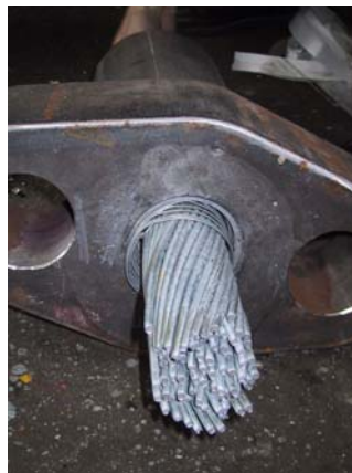
Essai de rupture de câble en usine
